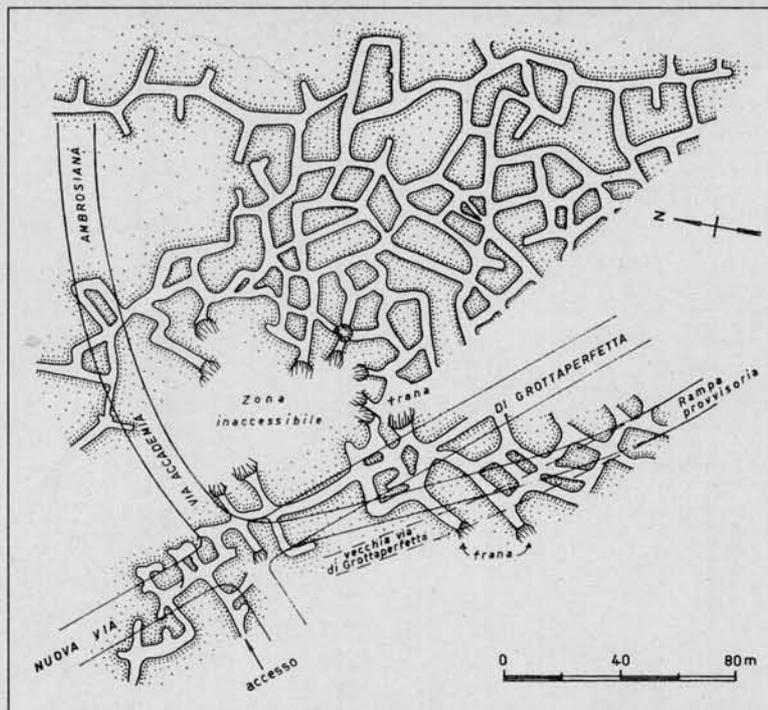
Fig. 6.3 - Pianta delle gallerie sotterranee esplorate nella zona di via Accademia Ambrosiana e nuova via di Grottaferfetta. La figura mostra l'andamento delle gallerie e la disuniformità della maglie da esse realizzate.
